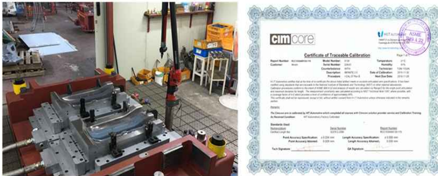
< 슬라이스 금형 치수정밀도 측정 사진 및 장비(CIM CORE) (좌)CIM CORE 검교정 성적서 (우)>
