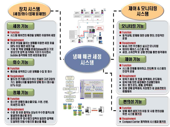
<냉매 배관 세정 시스템 및 서브시스템 기능분석, 요구분석>
