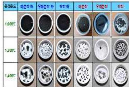
[그림] CO<sub>2</sub> 급속 가스화 시험 후 시료 모습
