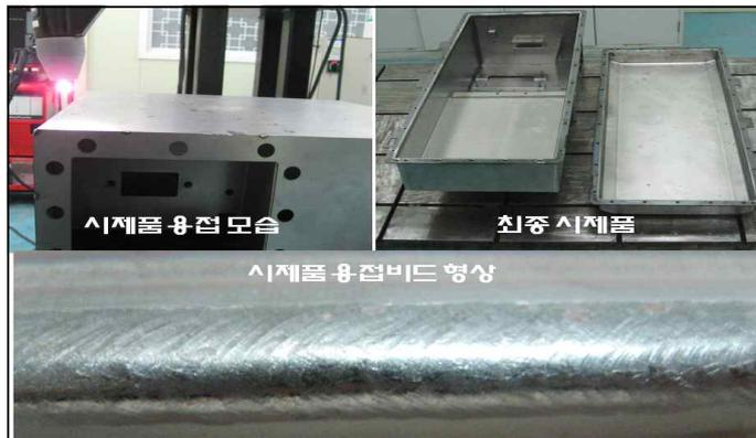
〈그림〉 배터리 케이스 시제품 플라즈마 용접 결과
